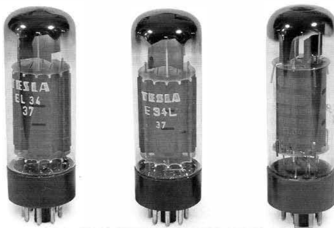
Tesla EL34 (1991), Tesla E34L (1991) and Svetlana EL34 (1999)
